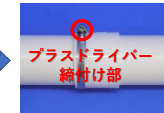
③パイプバンドをプラスドライバーで締め付けます。手で引っ張っても抜けない程度が目安です (締め付けすぎると、B-1、B-2が破損する恐れがあります)。
