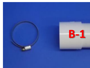
パイプバンドと B-1 ジョイント部
